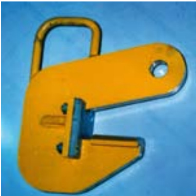
Rohrhaken mit Auflager entsprechend der Rohrkontur und austauschbarer Kunststoffplatte am Hakengrund.
