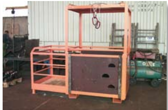
Arbeitskorb für Wartungs- und Reparaturarbeiten an Kran- und Hafenanlagen, mit Stapertaschen für den Transport mit Flurfahrzeugen. Der Korb enthält eine exzentrische Bühne zum Arbeiten unter festen Vorsprüngen.
