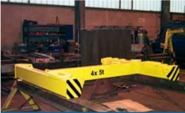
H-Traverse mit Längsverstellung und Anschlagpunkten für die Aufnahme von Containern im wehrtechnischen Bereich.
