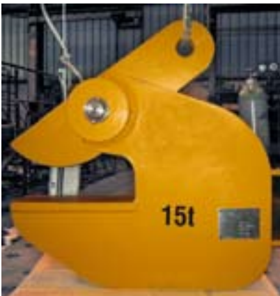
Rohrhaken mit Tragfähigkeit 15 t.
