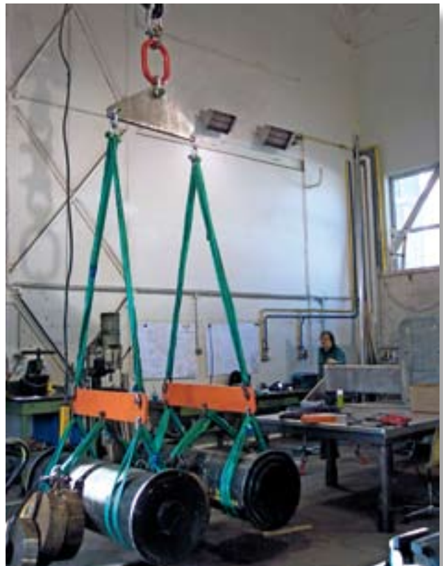
Ausgleichswippen-System mit oberer Zentralwippe und unteren Spreizbalken. Hier im Überlasttest.
