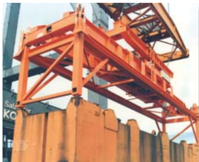
20' - 40'-Verstellspreader mit Drehtraverse. Die Kранаufnahme erfolgt über die beiden Seilrollenblöcke. Der Spreader ist an allen vier Seiten zur besseren Aufnahme der Container mit Eckflippern ausgestattet.
