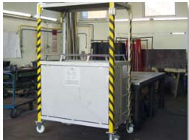
Arbeitskorb aus Edelstahl für den Einsatz in kerntechnischen Anlagen (mit Transportrollen).
