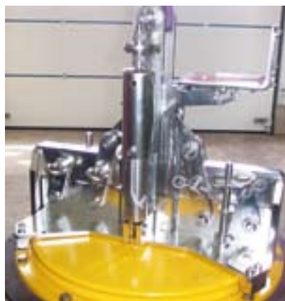
Mechanisch betriebter Fassgreifer in Edelstahlausführung für den Unterwassereinsatz.
