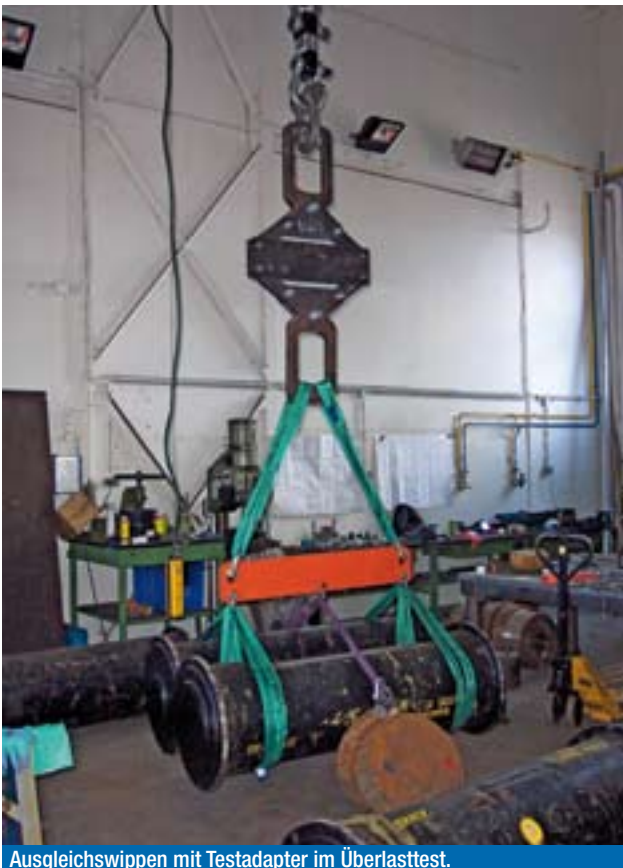
Ausgleichswippen mit mittiger Schäkelaufnahme und seitlichen Aufnahmehaken mit Hakenmaulsicherungen. Zur Aufnahme von vier Laststrängen. Tragfähigkeit 30 t.
