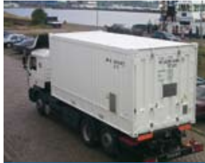
SiMaxx® 20'-OHT Typ A-Container für den Transport oder Lagerung von kontaminiertem Material gemäß den Anforderungen der GGVS/ADR und den IAEA Empfehlungen.
