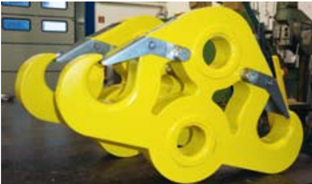
Ausgleichswippen mit mittiger Schäkelaufnahme und seitlichen Aufnahmehaken mit Hakenmaulsicherungen. Zur Aufnahme von vier Laststrängen. Tragfähigkeit 30 t.
