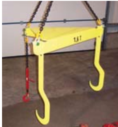
Hakengeschirr zur Aufnahme von kompletten Straßenbahnradsätzen inkl. Getriebe.
