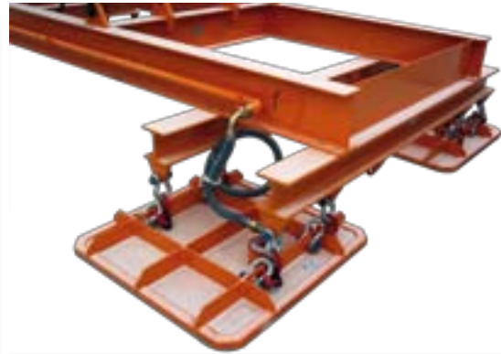
Detailansicht der quadratischen Saugschalen
