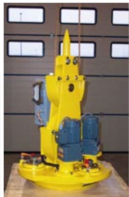
Motor betriebener Innen-Fassgreifer für den Einsatz im Trockenbereich.
