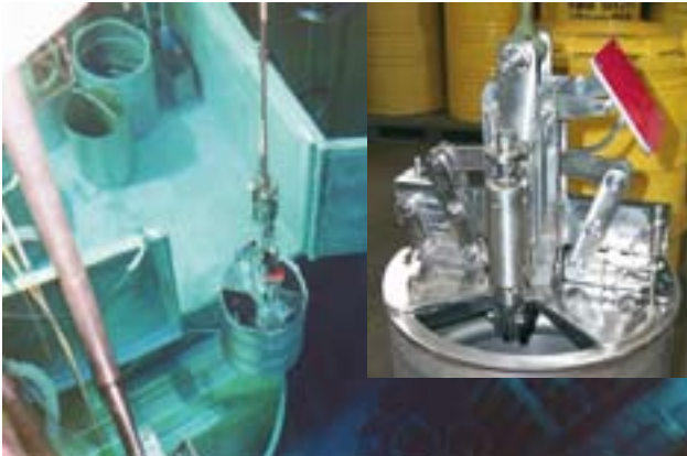
Rein mechanischer Fassgreifer zur Aufnahme von Primärbehältern im kontaminierten Unterwassereinsatz.
