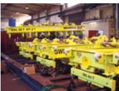
28 t-Pneumatiktraversen im Fertigungsprozess ...
