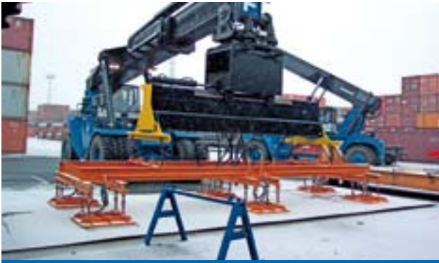
Traversensystem bestehend aus Rahmentraverse und modifizierbaren Quertraversen, hier als System bestehend aus sechs quadratischen Saugschalen mit einer Gesamt-Tragfähigkeit von 21 t.
