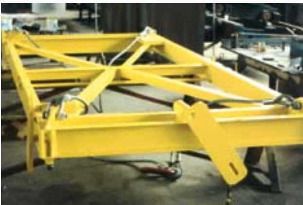
Festspreader für 20'- oder 40'-Standard-Container (hier 20'). Ausrüstung mit zwei stirnseitigen Handflippern.
