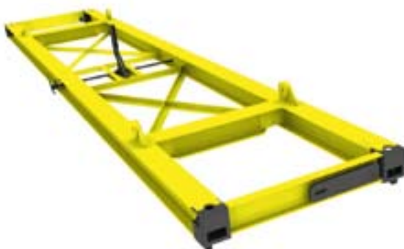
Halbautomatikspreader für 20'- oder 40'-ISO-Container. Automatische Verriegelung über Seilzugsystem zum Kranhaken. Alternativ mit Taststiften, um zu vermeiden, dass der Container angehoben werden kann, wenn der Spreader nicht ordnungsgemäß verriegelt ist.
