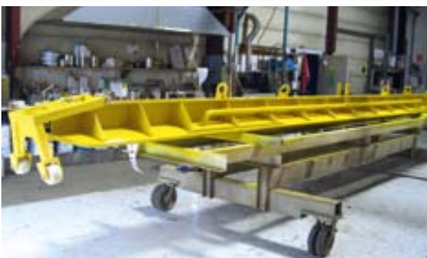
Vakuumsaugschale mit einer Safe Working Load (SWL) von 7,77 t während der Konservierung.
