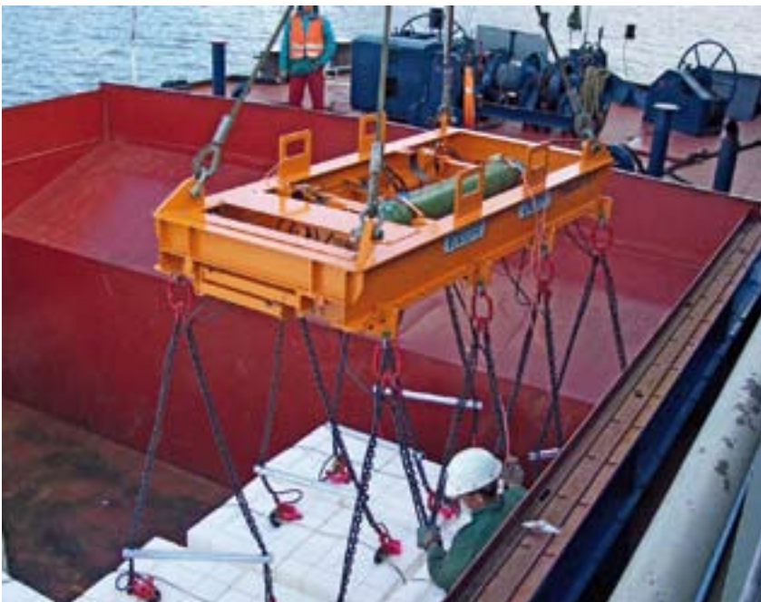
24 t-Pneumatiktraverse mit vier Lastträgern und jeweils vier Anschlagpunkten beim Anschlagen der Cellulosepakete.
