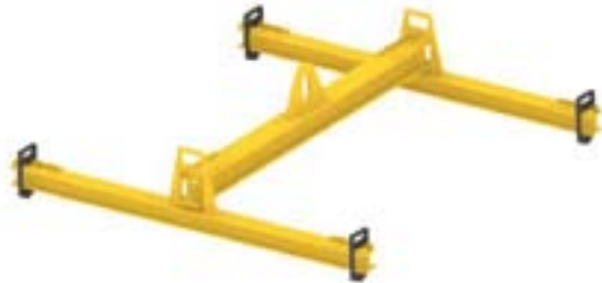
H-Traversen-System mit manueller Längsverstellung sowie individueller Verstellung der Anschlagpunkte an den Quertraversen mit einer Arbeitsbreite von max. 3 m und einer Tragfähigkeit von 5 t.
