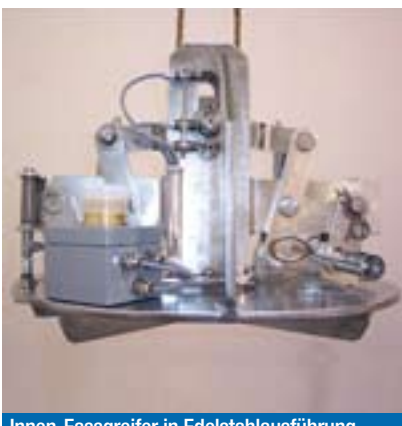
Innen-Fassgreifer in Edelstahlausführung für den Unterwassereinsatz mit elektrischen Kontakten zur Verriegelungsfernanzeige.
