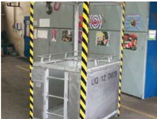
Arbeitskorb aus Edelstahl für den Einsatz in kerntechnischen Anlagen (ohne Transportrollen).
