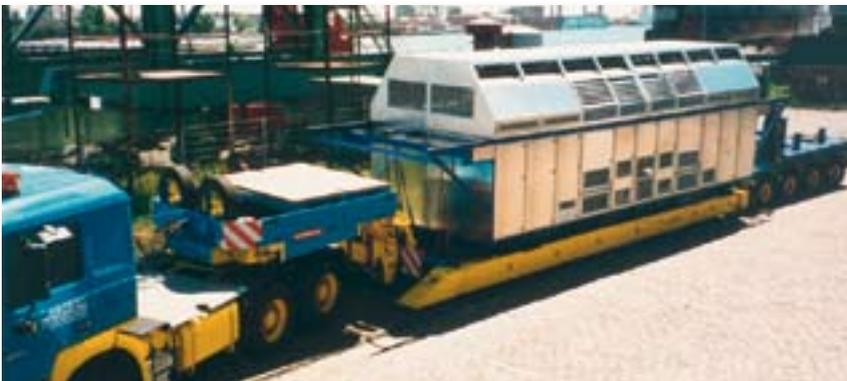
Transporteinrichtung für den Bahn- und Straßentransport (bestehend aus Lagergestell, Aufnahmen für Stoßdämpfer und Wetterschutzeinhausung) bei der Auslieferung.
