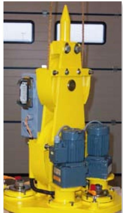
Motor betriebener Fassinnengreifer für den Einsatz im Trockenbereich
