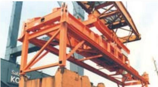
20- bis 40-Verstellspreader mit Drehtraverse
