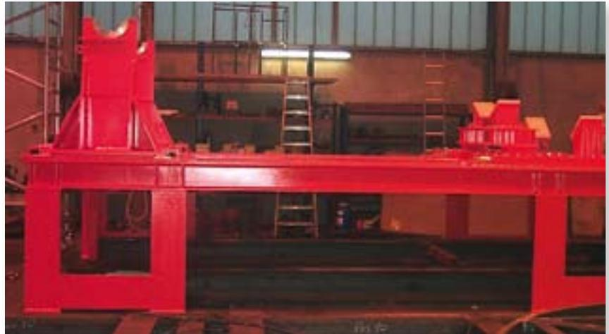
Das Ablagegestell verfügt über Aufnahmen für die Tragzapfen der Behälter und über ein Auflageprisma. Die Unterkonstruktion ist so ausgelegt, dass das Gestell von einem Spezialfahrzeug im Kraftwerk Krümmel unterfahren und aufgenommen werden kann.
