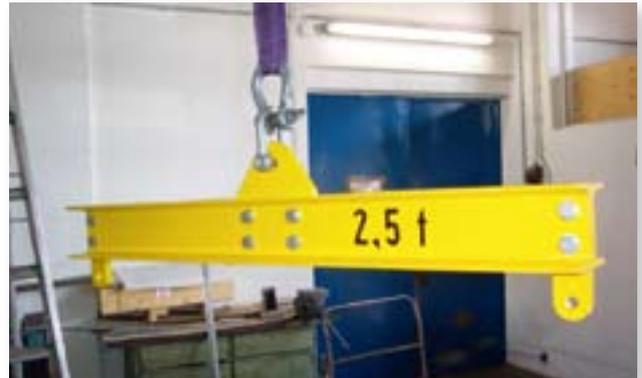
Traverse für das Kernkraftwerk Unterweser, Tragfähigkeit von 2,5 t
