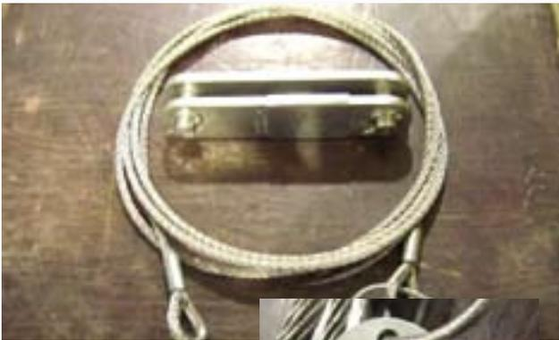
Verlängerungsseil für das Kernkraftwerk Würzgassen
