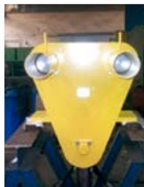
Hakenadapter für das Kernkraftwerk Würzgassen
