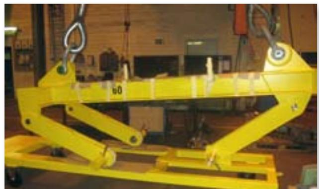
60 t-Traverse zur Handhabung von Betonriegeln einschließlich Transportwagen
