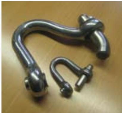
Edelstahlschäkel 18 t und 5 t nach durchgeführten Ganzerreiβversuchen zur Ermittlung der tatsächlichen Bruchkraft
