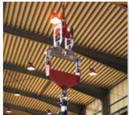
Vertikaltraverse aus Edelstahl inkl. Prüfadapter bei der dynamischen Überlastprüfung
