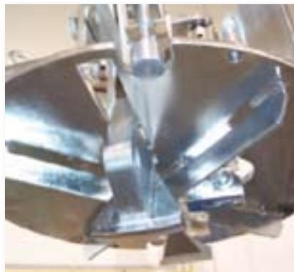
Unteransicht eines Fassinnengreifers mit Greiferklaue, Einweiserblechen und Taststift
