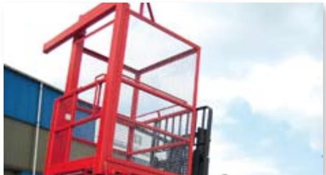
Arbeitskorb zum Anschlagen von Großbauteilen
