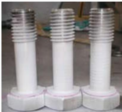
PT-Prüfung an mechanisch bearbeiteten Sonderschrauben aus Edelstahl
