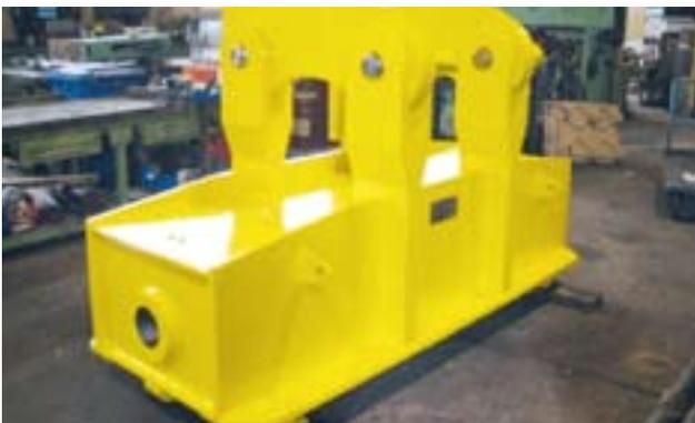
Schwerlasttraverse mit klappbaren Aufnahmen für Doppelhaken Nr. 125. Eigengewicht 3.350 kg, Tragfähigkeit 200 t
