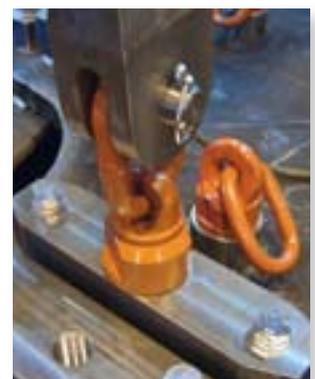
Schuhe für Hauptkühlmittelpumpe bei der Belastungsprüfung
