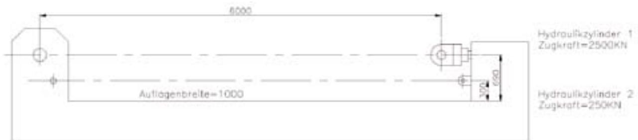
Hydraulische Testbank für statische Belastungsprüfung, geeicht bis 250 t
