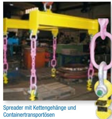
Spreader mit Kettengehänge und Containertransportösen
