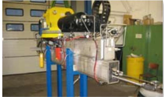
Reinigungs- und Beschichtungslanze für Reaktordruckbehälter
