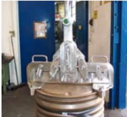
Halbautomatischer Fassgreifer für Presskartuschen
