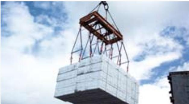
Pneumatiktraverse zum Umschlag von Cellulose-Paketen
