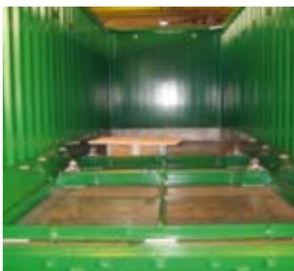
Einbaurahmen zur Maschinenaufnahme
