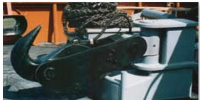
Hydraulisch ausgelöster Schlepphaken
