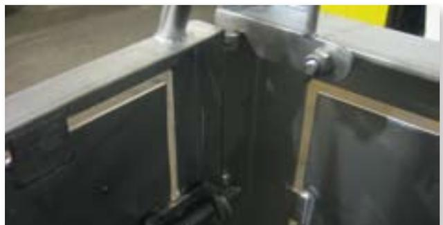
Detailansicht des zusätzlichen federbelasteten Sicherheitsriegels
