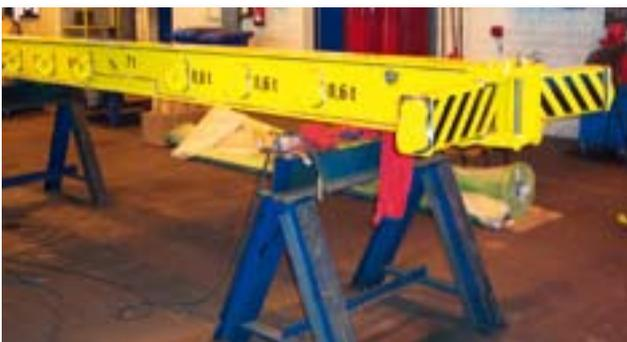
Kombitraverse, die als reine Balkentraverse oder als H-Traverse eingesetzt werden kann, in der Ausführung als Heissgeschirr.
