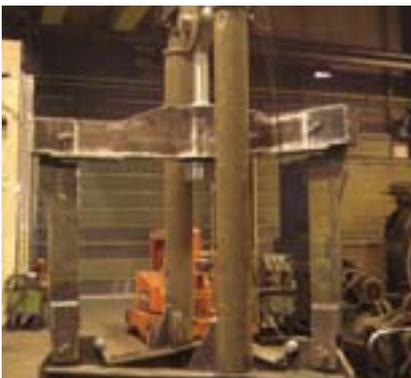
Dreiarmlige Universaltraverse bei der statischen Überlastprüfung in spezieller, hydraulischer Prüfvorrichtung
