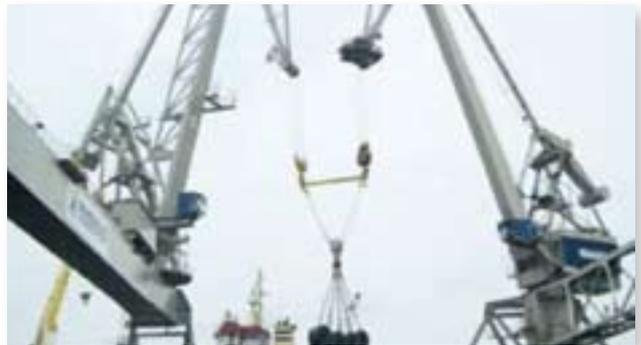
Schwerlasttraverse zum Tandembetrieb von Kranen
