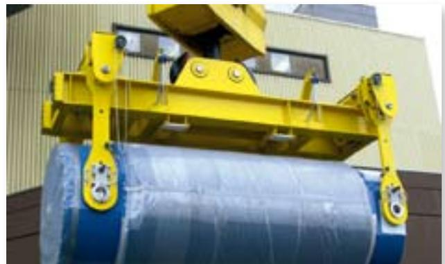
Horizontal- bzw. Außengehänge im Kernkraftwerk Grohnde in der verstellbaren Ausführung für verschiedene Anschlagmaße und Schwerpunktabstände in Längs- und Querrichtung. Eine gelenkig gelagerte Pendeltraverse garantiert eine statisch bestimmte gleichmäßige Lastverteilung auf alle 4 Tragzapfen.
