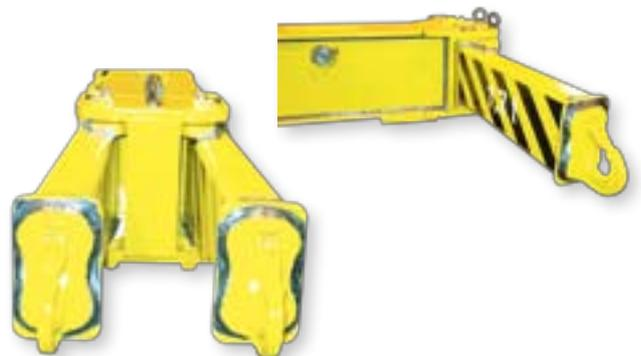
Detailsicht auf die Schweißnähte, die bei Heissgeschirren für die wiederkehrenden Prüfungen ohne Konservierung bleiben müssen.
