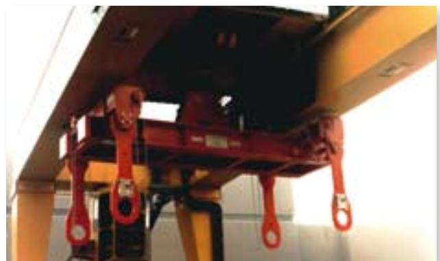
Horizontal- bzw. Außengehänge in obiger Ausführung im Kernkraftwerk Grundremmingen
