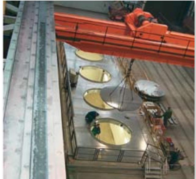
Arbeitsbühne für die Endmontage und Prüfungen von Brennelementbehälter bei der Montage in der GNS Betriebsstätte Mülheim
