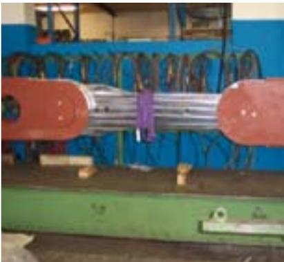
Wendelascbe mit Prüfadaptern auf Testbank bei Überlastprüfung von 110 t
