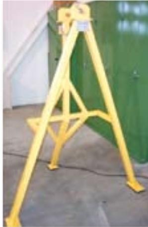
Absetzbock für Wendelasche für den Einsatz im Kernkraftwerk Grohnde
