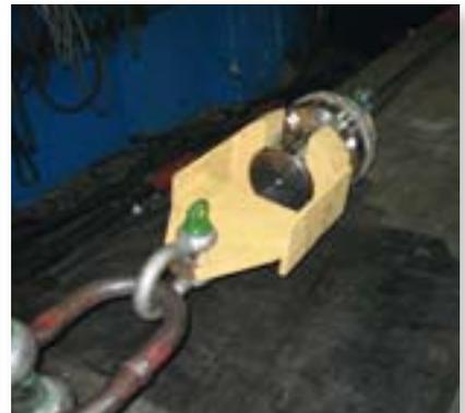
Traggilz für Deckelgehänge, inkl. Prüfadaptern auf der Testbank bei der Überlastprüfung von 9 t
