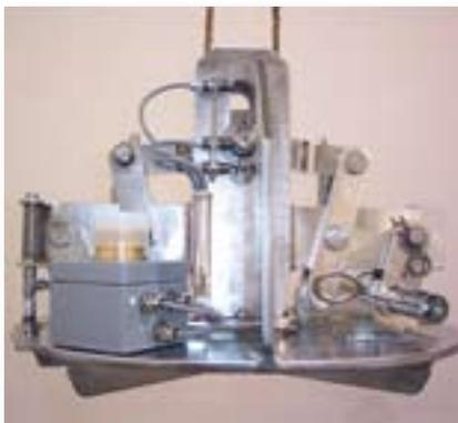
Fassinnengreifer in Edelstahlausführung für den Unterwassereinsatz mit berührungslosen Endschaltern zur Verriegelungsfernanzeige
