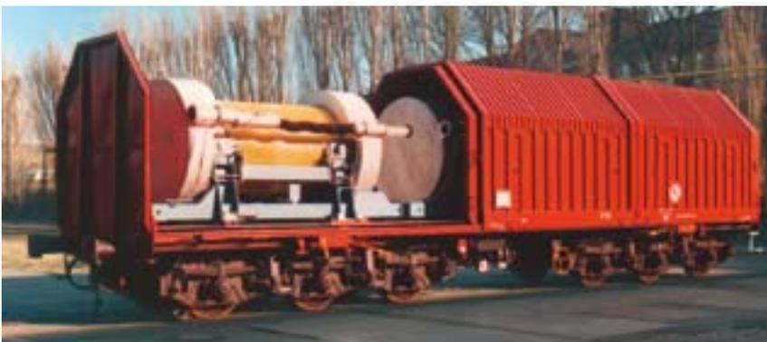
Transporteinrichtung (bestehend aus Lagergestell und Stoßdämpfern) mit Brennelementbehälter auf geöffnetem Eisenbahntransportwagen.
